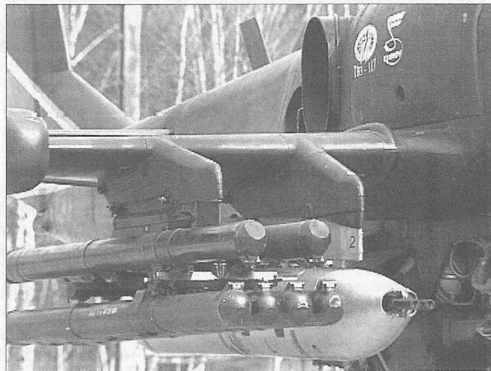
ПТУР «ВИХРЬ» и подвесной контейнер УПК 23-250 с двуствольной 23-х миллиметровой пушкой
